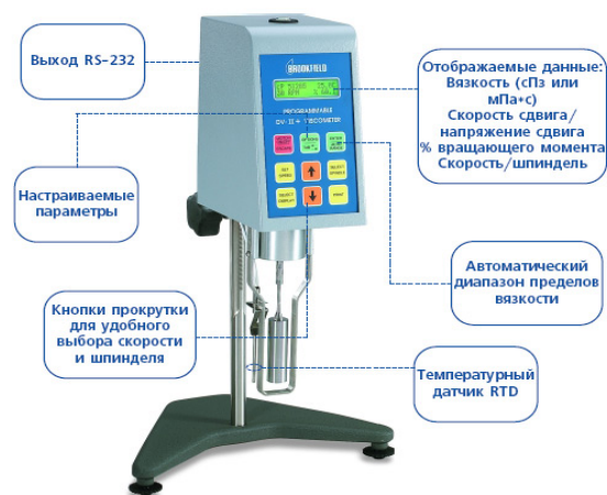
Рисунок 11 - Ротационный вискозиметр «Brookfield RVDV-II+».
